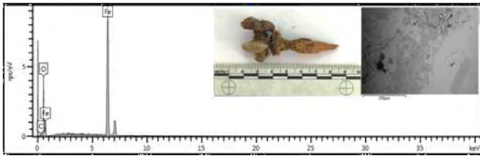
Figura 23 Espectro EDX de un clavo
