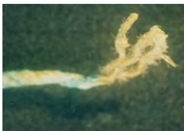
Fig. 7. Microfotografía. Hilado formado por 3 cabos
