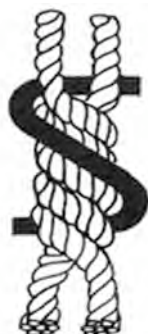
Fig. 4. Retorsión, es la dirección en la que se retuercen en forma conjunta 2 o más hilados
