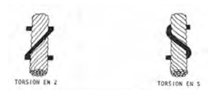
Fig. 2. La torsión se refiere a la dirección en la que se hila o tuerce, y puede ser hacia la izquierda (S) o hacia la derecha (Z)
