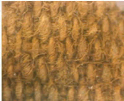
Fig. 20. Microfotografía. Tejido con la técnica tafetán cara de urdimbre
