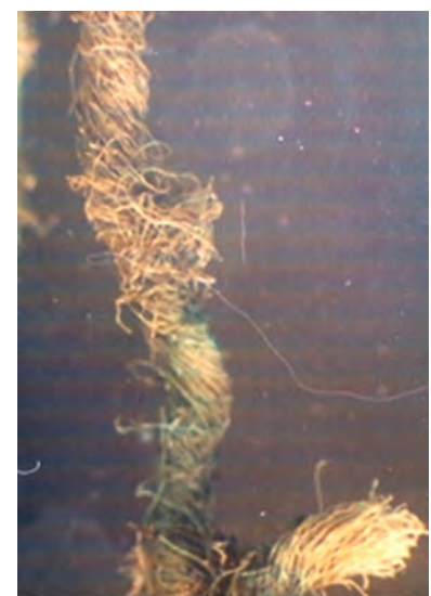
Fig. 3. Fibra de algodón Torsión en "S"
