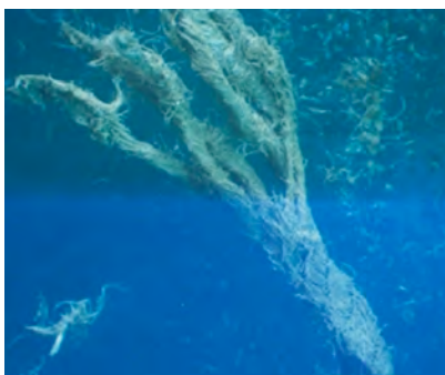
Fig. 5. Retorsión 1 (S-Z), 7 cabos
